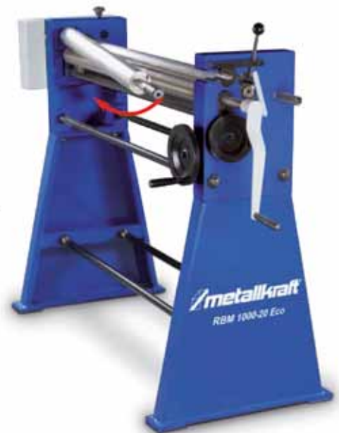
· Ober- und Unterwalze einzeln durch Handrad verstellbar
